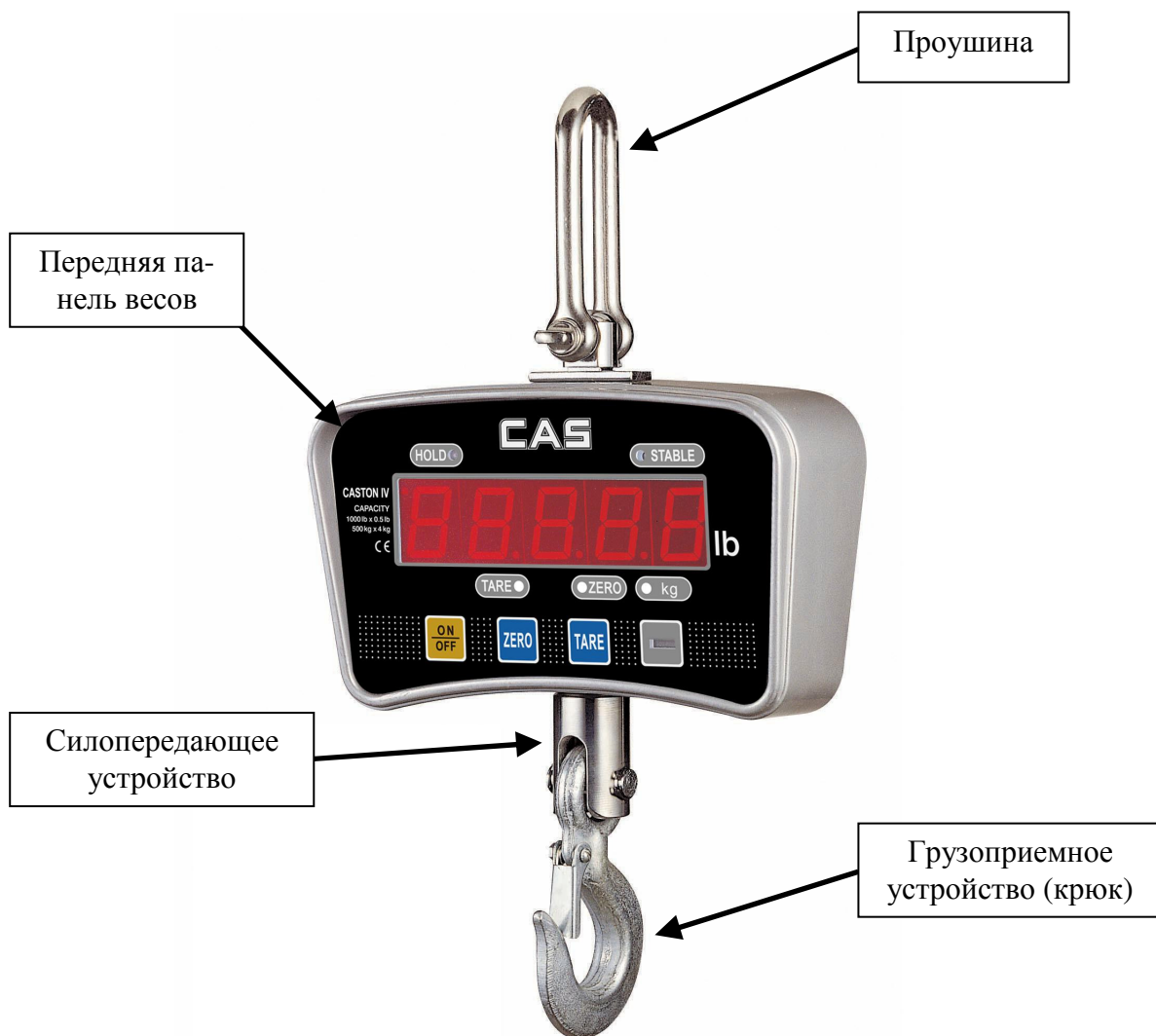
Рисунок 4.1 Общий вид весов ТНА и обозначение основных элементов
